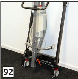
Für eine kurzzeitige Lagerung kann der Lifter geklappt (**Seite 27**), auf die **gebremsten** hinteren Rollen gestellt und platzsparend an eine Wand gelehnt werden. (**Abb. 92**)
