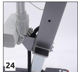
**Fehlt** der Bolzen (Abb. 24) oder ist er **nicht bis zum Anschlag eingebaut** (Abb. 25), sind die elektrischen Hebefunktionen **gesperrt**. Das gilt für **alle drei Positionen** des Standmastes.
